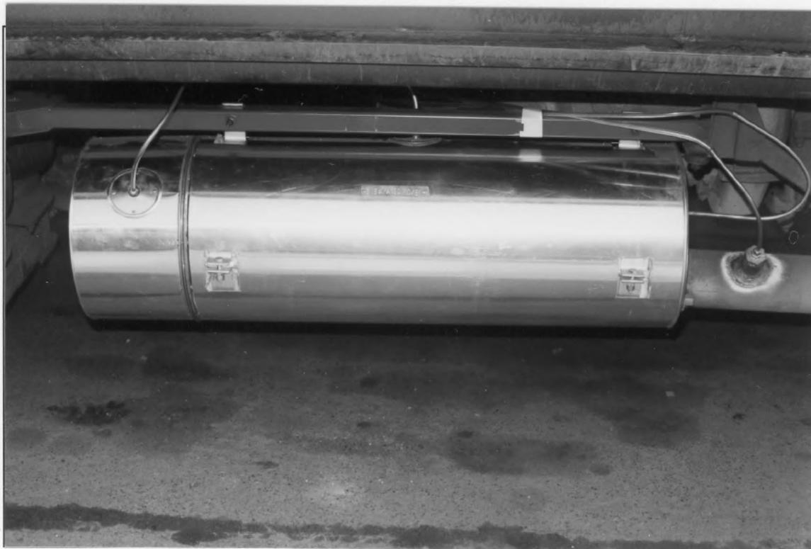
Dispositivo ENEA/Atec su DE SIMON AU 280 FT predisposto per le prove; si notano le aperture sul mantello protettivo esterno necessarie al serraggio delle fasce di sostegno.
