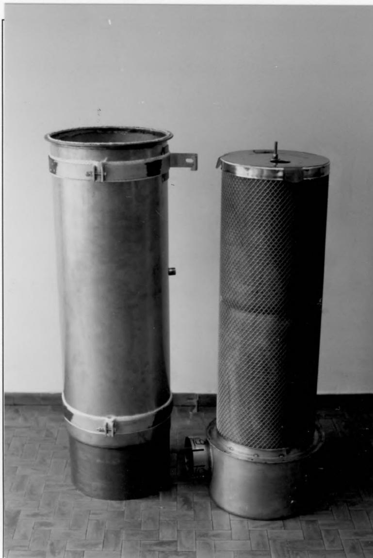
Testata con cartuccia catalitica di un dispositivo del secondo lotto prima dell'assemblaggio con il corpo esterno del dispositivo.
