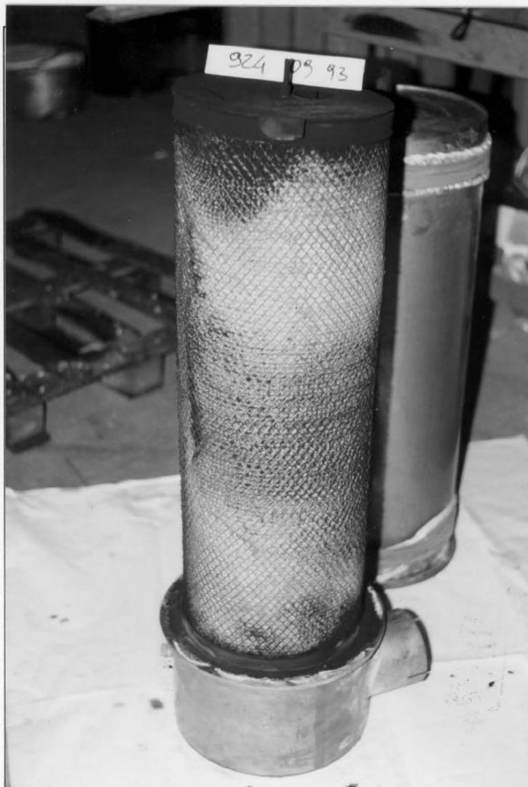
Autobus 924. Si evidenzia l'ottima tenuta della fibra ed una altrettanto buona distribuzione del flusso del gas. Questo dispositivo presenta un solo foro di scarico della pressione di testata.
